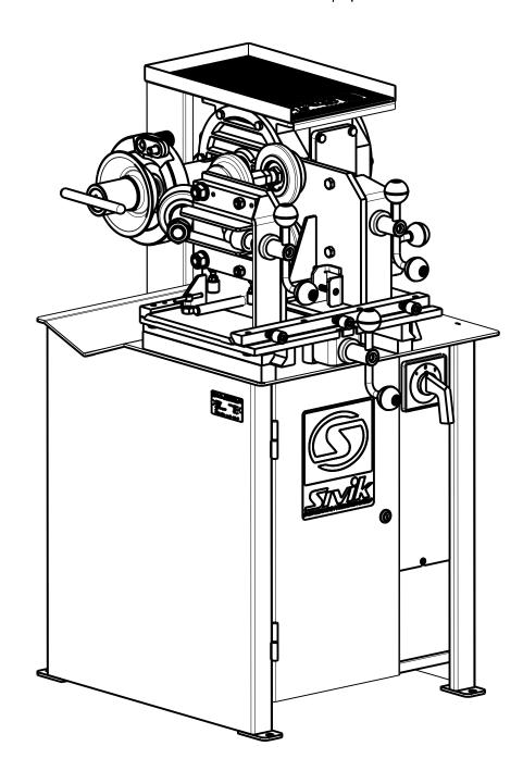
Каталог деталей и сборочных единиц стенда для реставрации ободьев автомобильных колес Титан ST/17 КС703.000.00, предназначен для составления заявок на запасные части при техническом обслуживании и ремонте. Пользование Каталогом облегчает определение деталей и сборочных единиц, выполнение расчета потребности, составление заявок, планирование снабжения запасными деталями и сборочными единицами.
